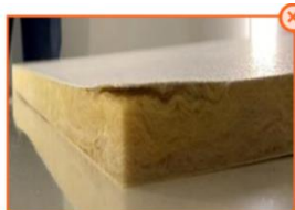
Délamination de la surface
